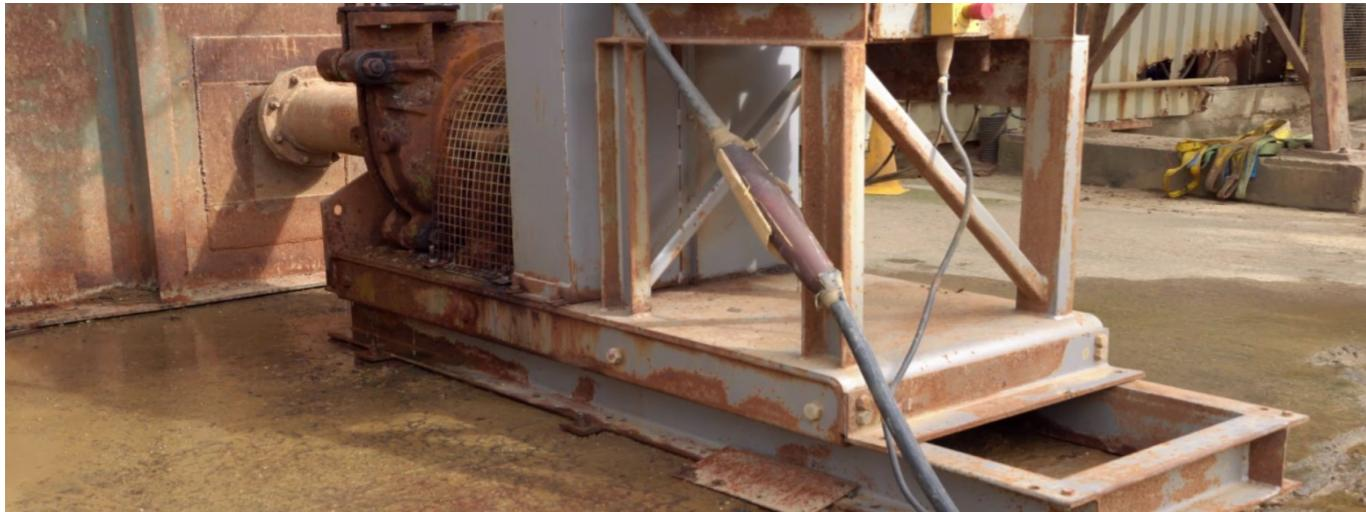
Les pompes à boues sont généralement de grande taille et les opérations de maintenance et les réparations sont reconnues comme difficiles sur ce type de pompe. Ce sont des tâches qui nécessitent généralement plus d'une personne, l'utilisation d'appareils de levage et qui présentent le risque de blessures potentielles pour ceux qui entreprennent l'opération.
